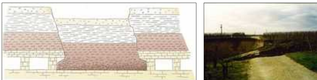
Fig. 12 : Schéma conceptuel d'un effondrement généralisé [Source : BRGM] et photographie d'un effondrement généralisé à SAINT-EMILION (Gironde) [Source : CG 33]
