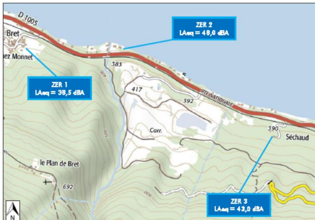
Figure 55 : Localisation des points de mesures acoustiques réalisées sur la zone d'étude « Carrière »
