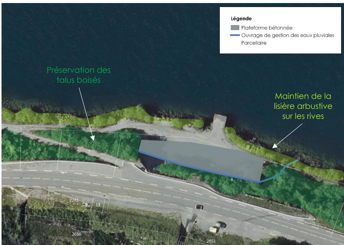
Figure 59 : Schéma de l'aménagement prévu au niveau du ponton du Locum – Source : KARUM
