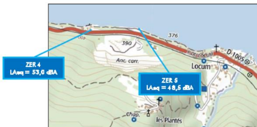
Figure 56 : Localisation des points de mesures acoustiques réalisées sur la zone d'étude « Ponton du Locum »
