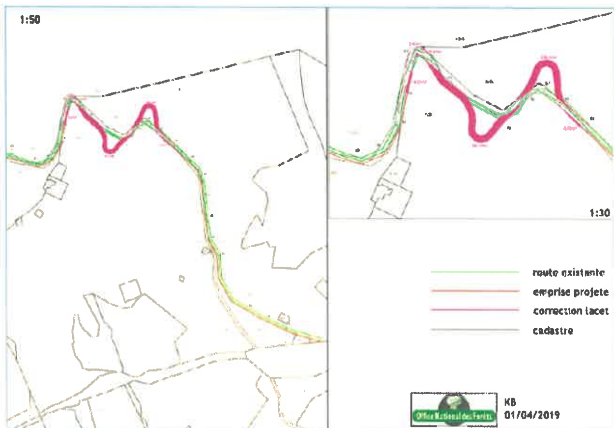
Principe de reprise des virages sur la partie haute de la route au col de Voza
