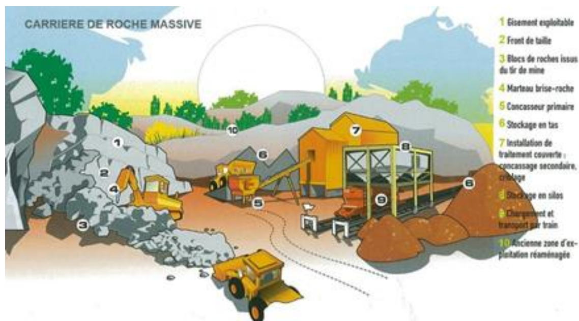
Figure 23 : schéma théorique d'exploitation d'une carrière de roche massive
