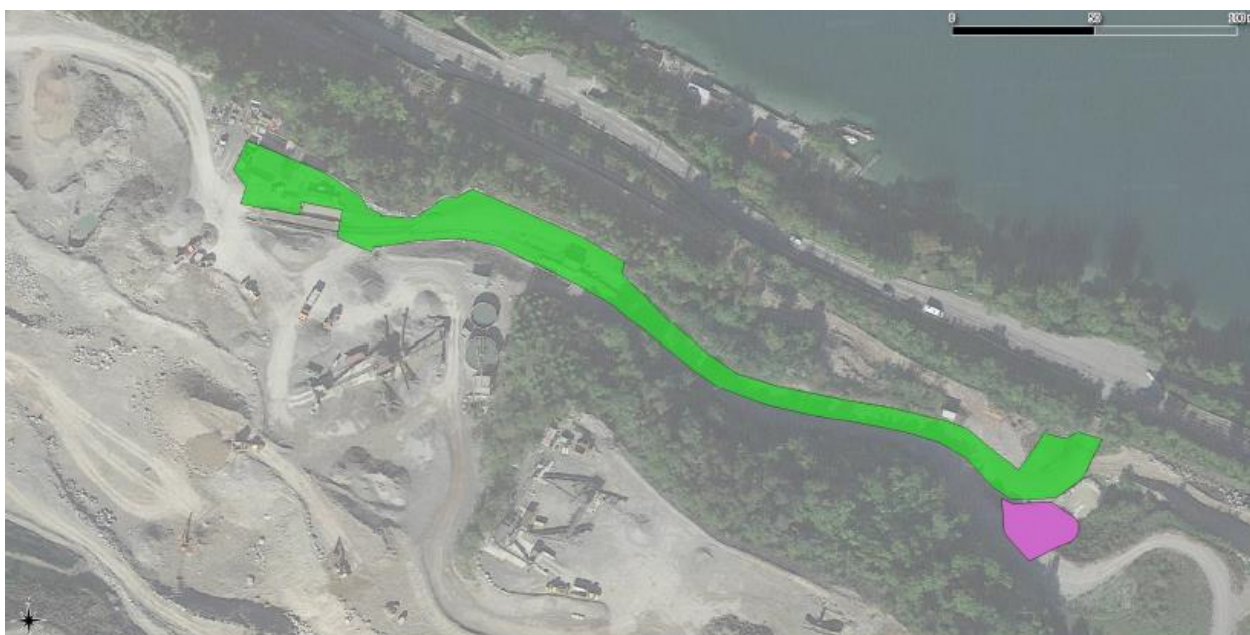
Figure 17 : Surfaces étanchées considérées pour la gestion des eaux pluviales de ruissellement – Source : His&O, étude hydraulique
