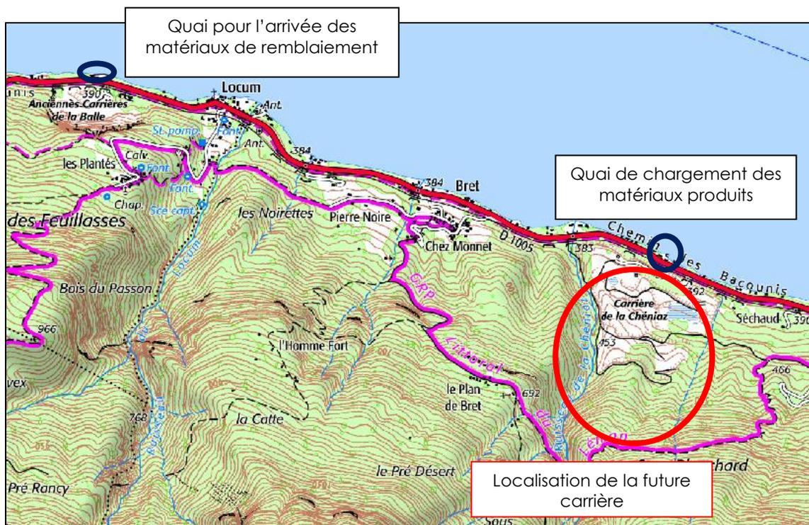
Figure 9 : Plan de localisation des sites de chargement/déchargement des matériaux
