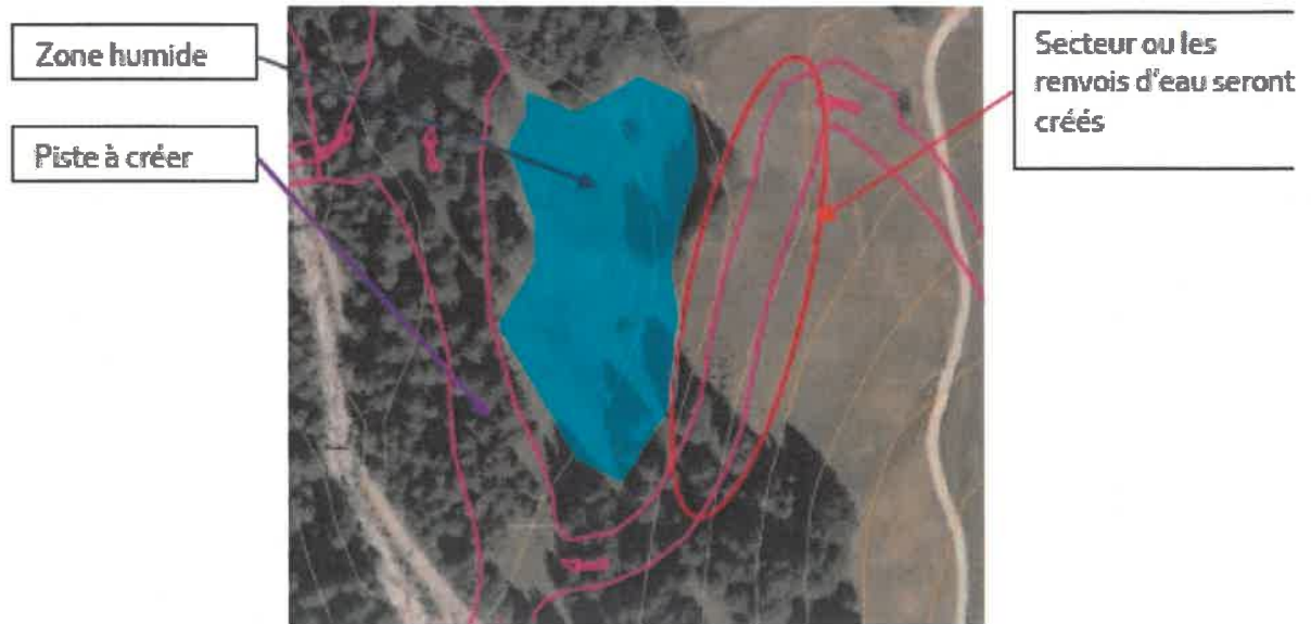
Figure 2 Création de renvois d'eau au niveau de la piste à créer pour préserver la zone humide n°10
