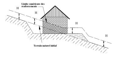
(parement exposé aux éboulements subvertical et renforcé, dimensionnement pour résister aux efforts prévisibles...).
